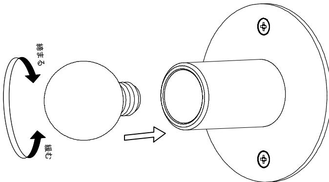
付属の電球をソケットに確実に取り付けてください。
